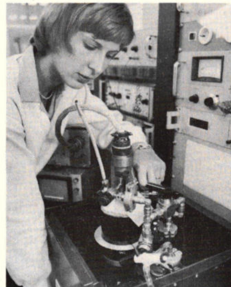
Afb. 7. Meetopstelling voor het beproeven van detector-dewar-flessen bij een temperatuur van 77 K.
