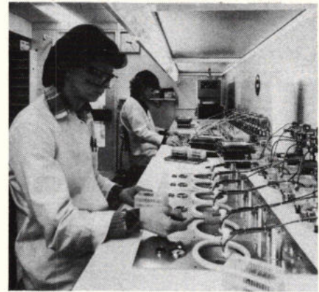
Afb. 3. In de begin 1979 in bedrijf genomen produktiestraat in de halfgeleidercomponentenfabriek te Heilbronn (BRD) krijgen de halfgeleiderschijven een voor ultravioletlicht gevoelige laklaag opgebracht ten behoeve van de structurering van het oppervlak. Door hun verschillende formaten, grootten en breukgevoeligheid moeten de schijven met de hand op de draaitafel worden gelegd.
